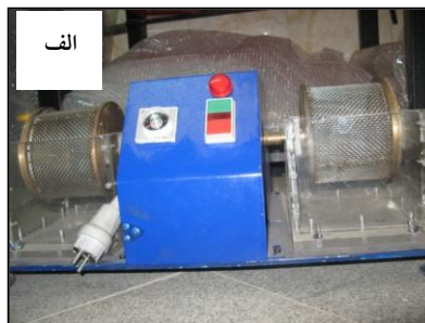
شکل ۱. الف) دستگاه آزمایش دوام استاندارد [۶]، ب) تعدادی از نمونه‌های تهیه شده برای آزمایش
