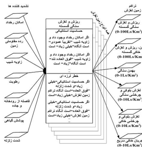
شکل ۷. نمودار جریانی داده‌ها بر ای بخش خطر CAMEL، معرف ورودی‌ها (اطلاعات تشدید کننده)، خروجی‌ها، و ترتیب قواعد [۱۰]، [۱۱]، [۱۲]
