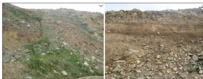
شکل ۷. تصویر قرارگیری قطعات آندزیت بازالت به‌طور ناهمگن در مجاورت مصالح ماسه، سیلت و رس
