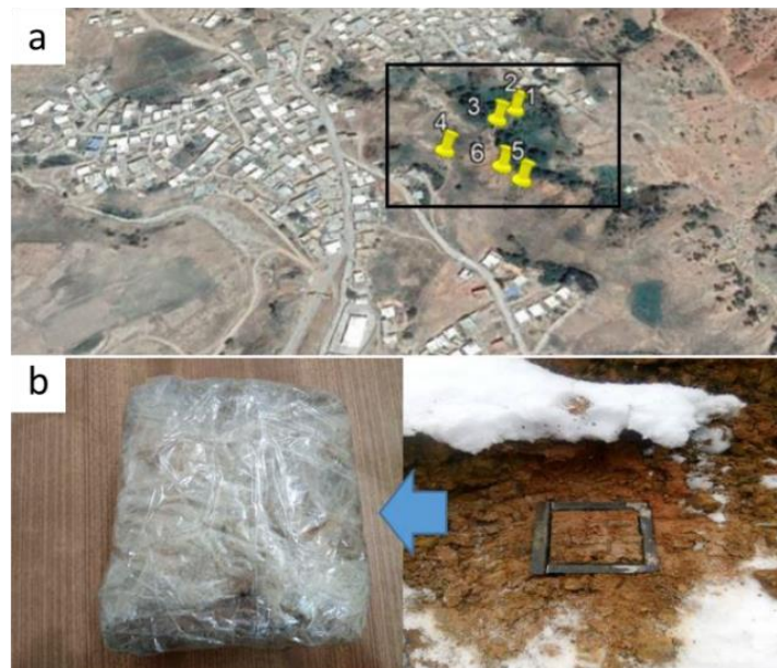
شکل ۳. a) موقعیت نقاط نمونه برداری و b) تصاویری از نمونه برداری دست نخورده بلوکی و استوانه‌ای Fig. 3. a) Location of sampling points, and b) images of undisturbed block and cylindrical sampling
