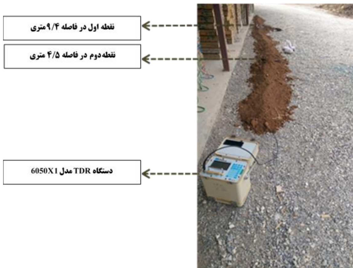
شکل ۶. تصویر آزمایش ارزیابی تأثیر رطوبت خاک اطراف سنسور TDR بر شکل موج آن و موقعیت نقاطی که رطوبت خاک به صورت پله‌ای افزایش داده شد.
