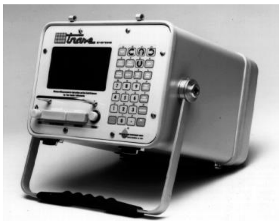
شکل ۳. دستگاه رطوبت سنج TDR شرکت Soil moisture مدل 6050x1. Fig. 3. TDR moisture meter of Soil moisture company, model 6050x1.
