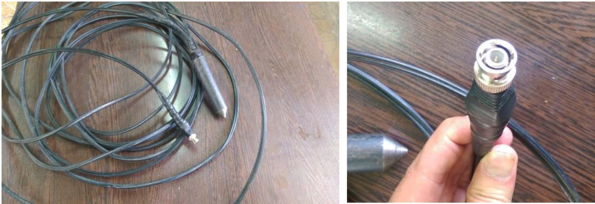
شکل ۴. کابل دو رشته‌ای مخابراتی و تبدیل پورت دو رشته‌ای به BNC Fig. 4. Bi-wire telecommunication cable and conversion of Bi-wire port to BNC
