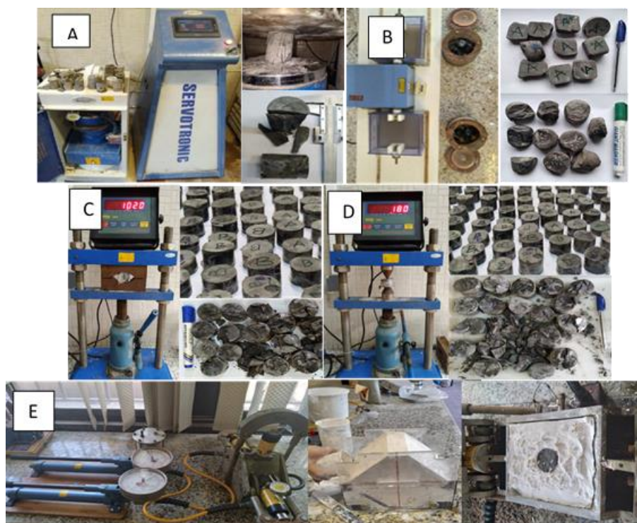
شکل ۴. تصاویری از دستگاه و نمونه‌های قبل و بعد از آزمایشات (A) فشار مقاومت تک محوری، (B) دوام پذیری، (C) آزمایش برزیلی، (D) آزمایش بار نقطه‌ای (E) آزمایش برش مستقیم
