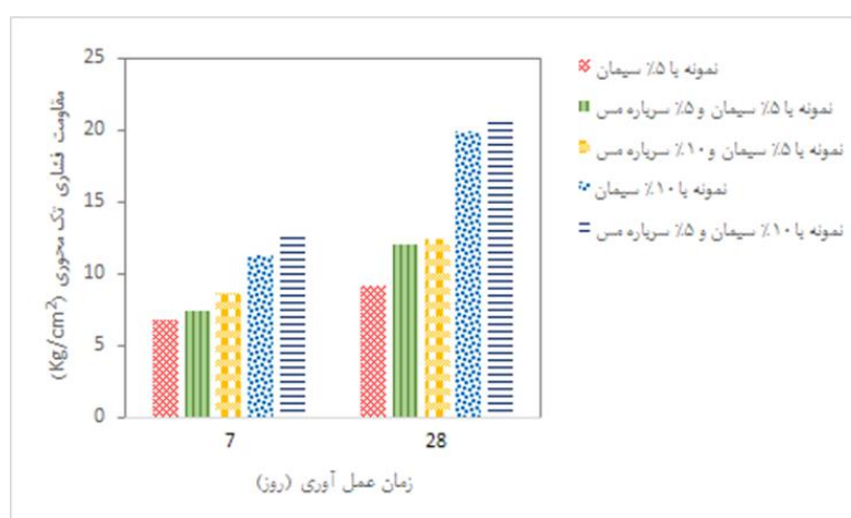
شکل ۱۶- تاثیر زمان عمل آوری بر مقاومت فشاری تک محوری نمونه‌های ساخته شده با تراکم ۹۰ درصد و رطوبت سمت
