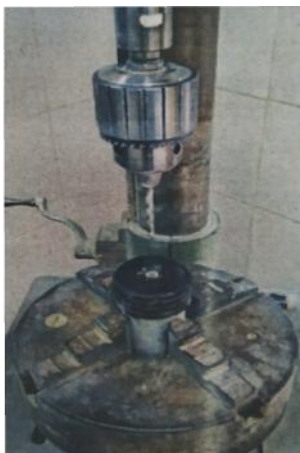
شکل ۲. سوراخ کاری نمونه‌های سیمانی
