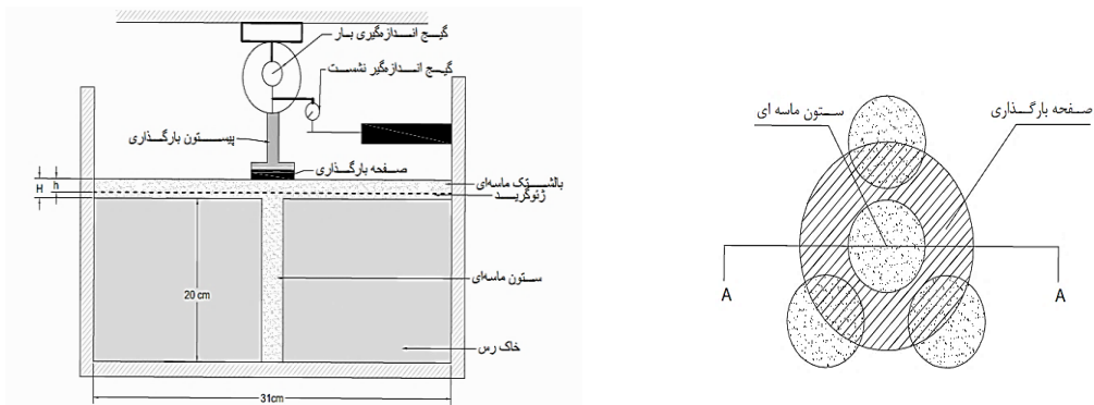
شکل ۴. شکل شماتیک جعبه و نمونه آزمایش.
