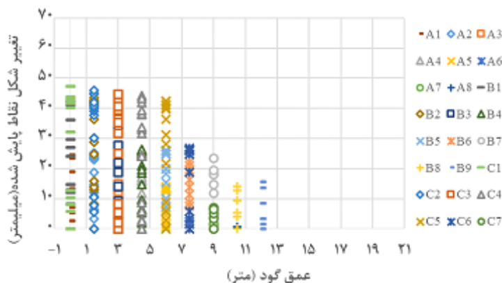
۶. تغییر شکل جانبی نقاط پایش شده درون گود
