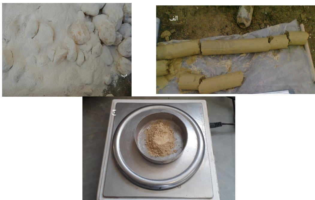
شکل ۱: مصالح مورد استفاده در تحقق حاضر: الف- خاک رس، ب- پودر سنگ آهک، ج- نانو رس.
