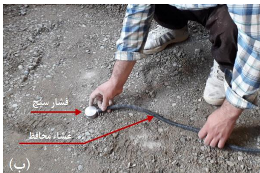
شکل ۵. تصویر واقعی از الف) بخش‌های مختلف دستگاه، ب) فشار سنج
