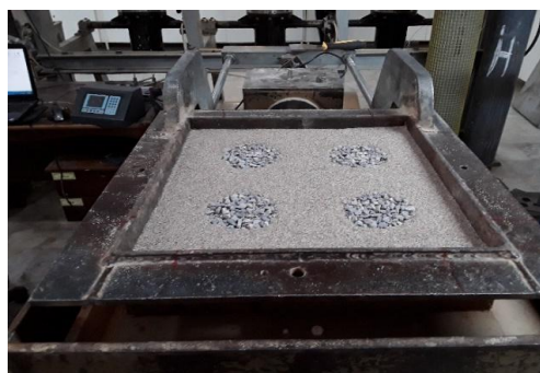
شکل ۵. آرایش قرارگیری ستون‌های سنگی در آرایش مربعی الف) ۸/۴٪، ب) ۱۲٪، ج) ۱۶/۴٪
