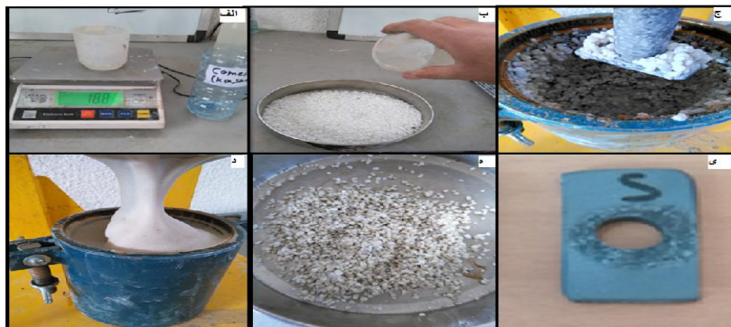
شکل ۱۲- مراحل انجام آزمایش تعیین ساینده‌گی مصالح فوم دار، الف) وزن کردن فوم، ب) افزودن فوم به مصالح، ج) آزمایش در حالت خیس شدگی، د) آزمایش در حالت مصرف زیاد فوم، ه) تصویر دانه‌ها بعد از آزمون، ی) تصویر ایمپلر بعد از آزمون
