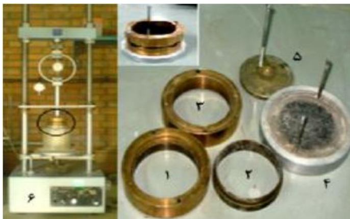
شکل ۱. قالب تراکم استفاده شده برای ساخت نمونه‌ها
