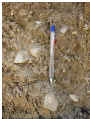
شکل ۶. دانه‌های درشت گردگوشه در رس آبرفتی
