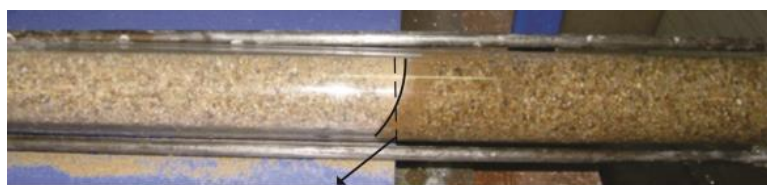
شکل ۳. محل قرائت طول نفوذ در نمونه
