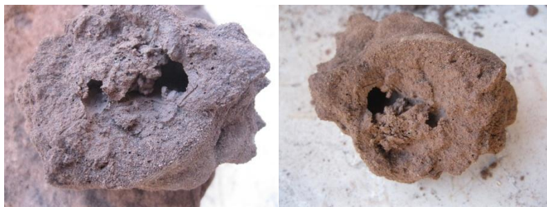
شکل ۱۵. آثار حفرات ناشی از انحلال (نمونه ۲۱)
