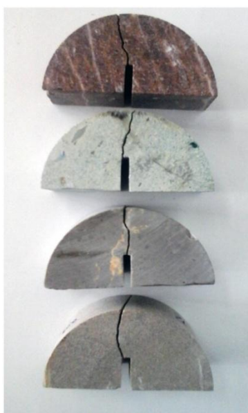
شکل ۳. نمونه‌ها بعد از آزمایش برای نوع سنگ ۴ (از بالا به پایین آندزیت، توف سبز، سنگ آهک و ماسه سنگ)
