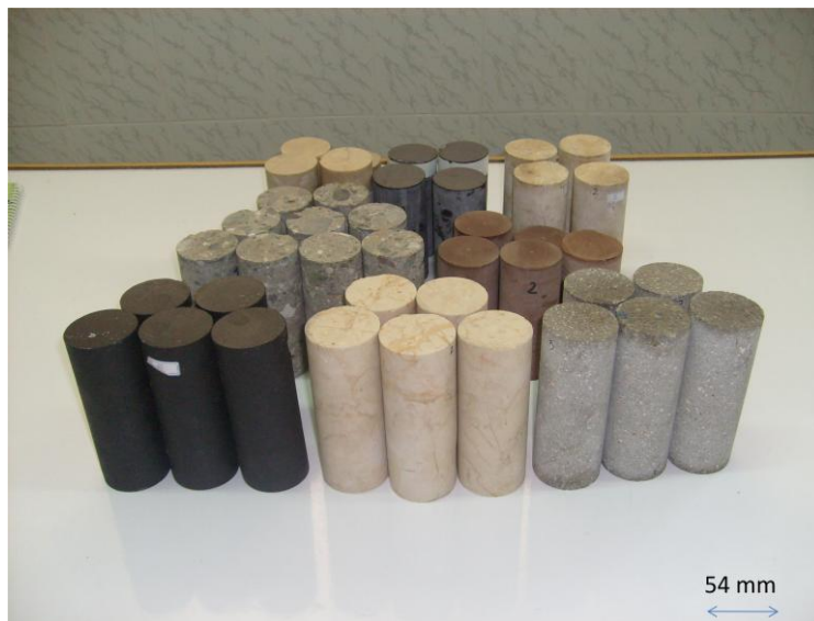
شکل ۶. مغزه‌های استوانه‌ای آماده‌سازی شده برای آزمایش اولتراسونیک
