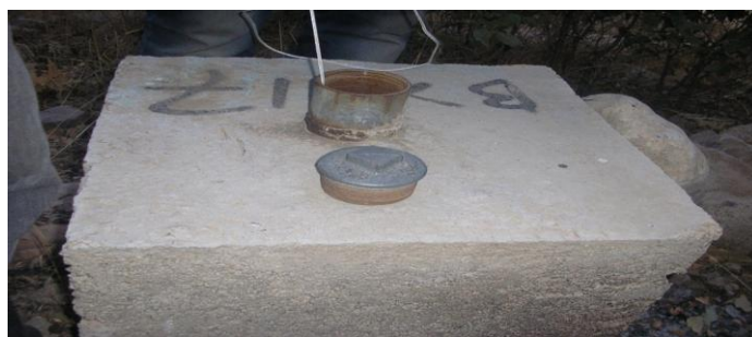
شکل ۳. تصویر کلی یک پیزومتر
