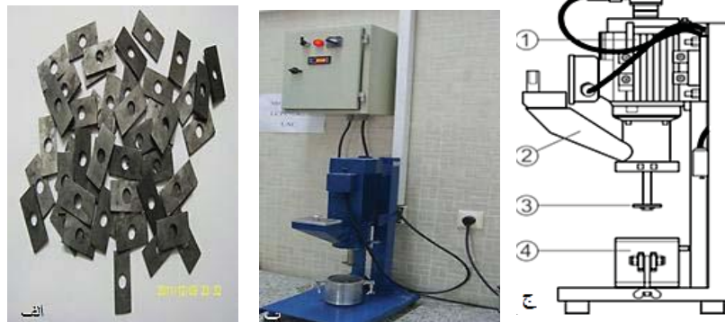
شکل ۵. مجموعه تجهیزات آزمایش LCPC با پروانه آن [۱۰]
