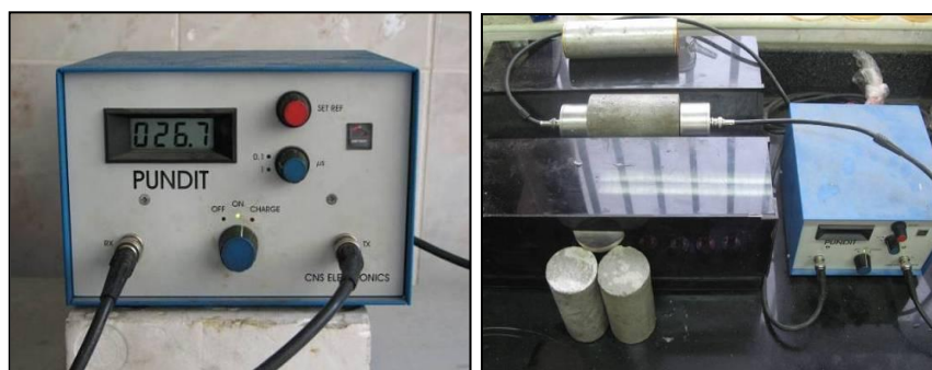
شکل ۳. تعیین سرعت موج فشاری بر روی مغزه‌ها
