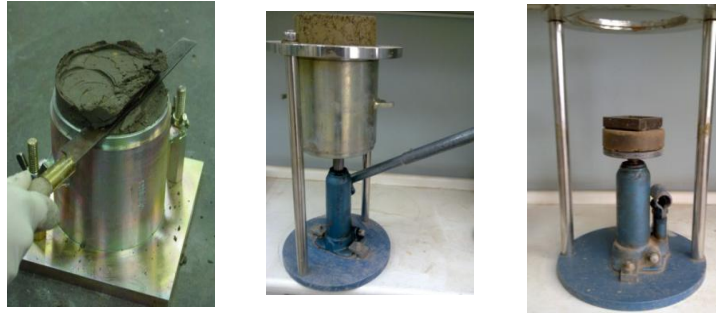
شکل ۶. الف) نحوه خارج کردن نمونه با استفاده از جک هیدرولیکی، ب) نحوه قالب‌گیری با استفاده از جک هیدرولیکی، ج) نحوه پر کردن قالب برش
