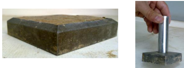
شکل ۴. کوبه فلزی و خاک متراکم شده در قالب برش مستقیم
