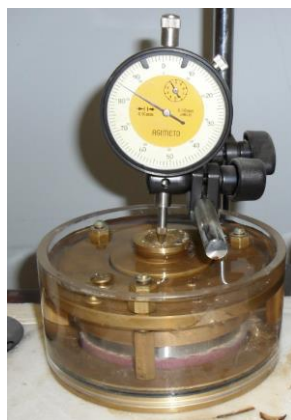
شکل ۳. دستگاه ادومتر مورد استفاده برای اندازه‌گیری تورم آزاد با بار ثابت
