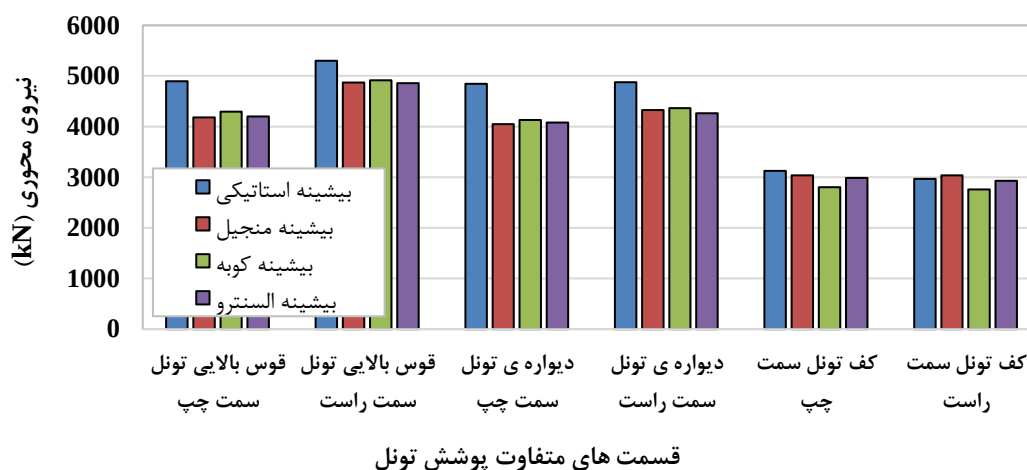
شکل ۲۲. بیشینه مقادیر نیروی محوری در قسمت‌های متفاوت تونل در شرایط لرزه‌ای گوناگون
