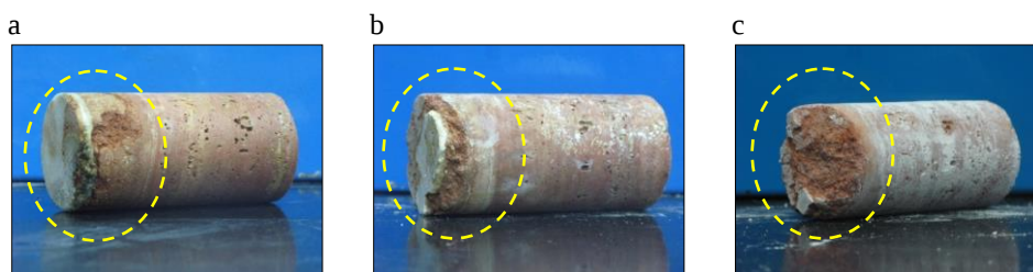
شکل ۱۲. زوال شیمیایی تراورتن بعد از آزمایش تبلور نمک (a) ۴۰ چرخه (b) ۵۰ چرخه و (c) ۶۰ چرخه (خطوط غیرممتد زوال را نشان می‌دهند)
