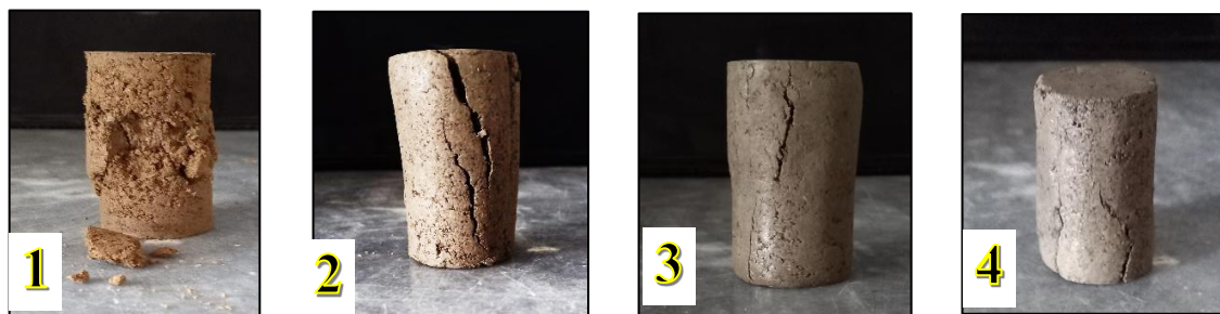
شکل ۷. نحوه شکست نمونه‌های خاک بدون افزودنی و مسلح شده با خاکستر پوسته برنج
