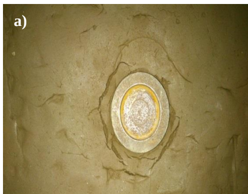
شکل ۷. تغییرات سطح نمونه‌ها پس از بارگذاری: (a) رس و (b) ماسه.
