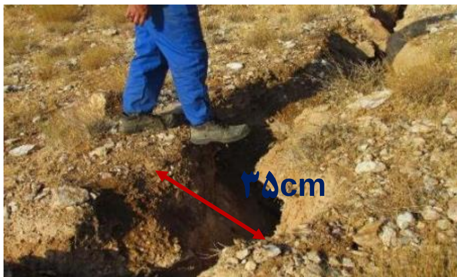
شکل ۱۶- نمونه درزه کششی در سنگ‌های شیستی معدن سنجده
