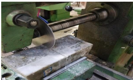
شکل ۳. نحوه ایجاد ترک در قطعات نیم‌دیسک
