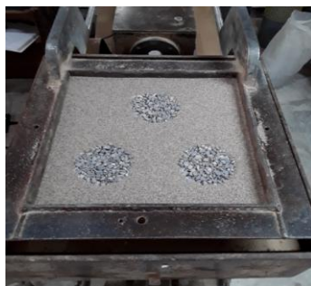
شکل ۶. آرایش قرارگیری ستون‌های سنگی در آرایش مثلثی الف) ۸/۴٪، ب) ۱۲٪، ج) ۱۶٪
