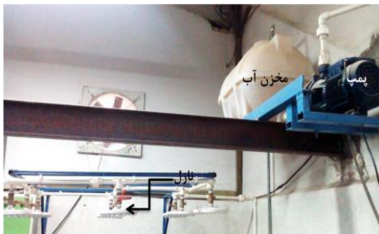
شکل ۴. بخش‌های مختلف دستگاه شبیه‌ساز باران استفاده شده
