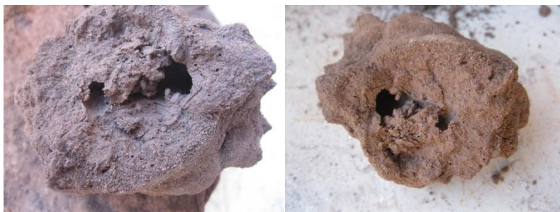
شکل ۱۵. آثار حفرات ناشی از انحلال (نمونه ۲۱)
