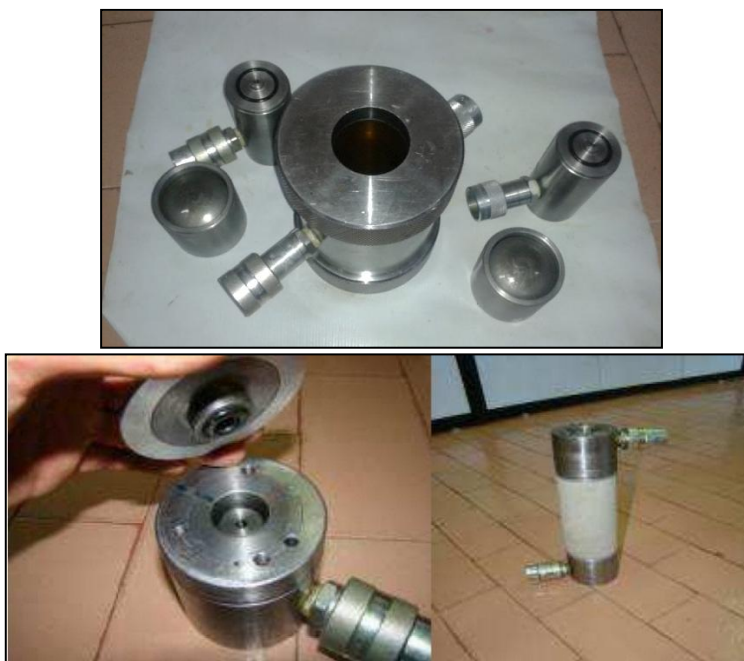
شکل ۲. سلول هوک و درپوش‌های ساخته شده برای مناسب‌سازی سلول برای آزمایش شکست هیدرولیکی
