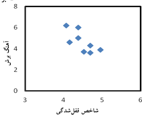
شکل ۱۱. ارتباط بین شاخص قفل‌شدگی و آهنگ برش
