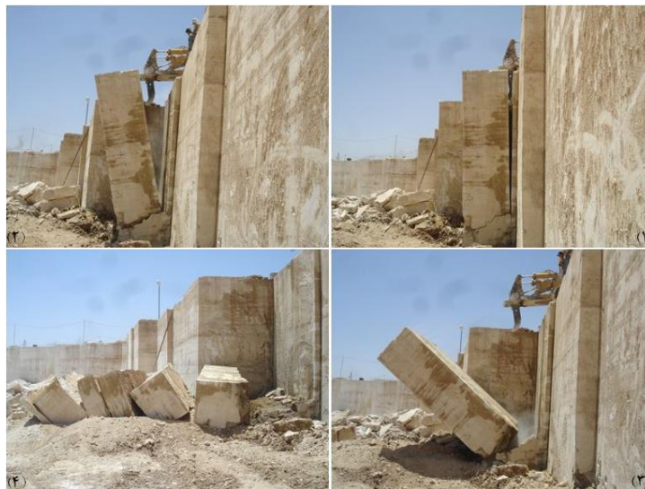
شکل ۳. مراحل استخراج یک بلوک سنگ (دارای لایه‌بندی ظریف) در یکی از معادن تراورتن مجتمع معدنی حاجی‌آباد محلات
