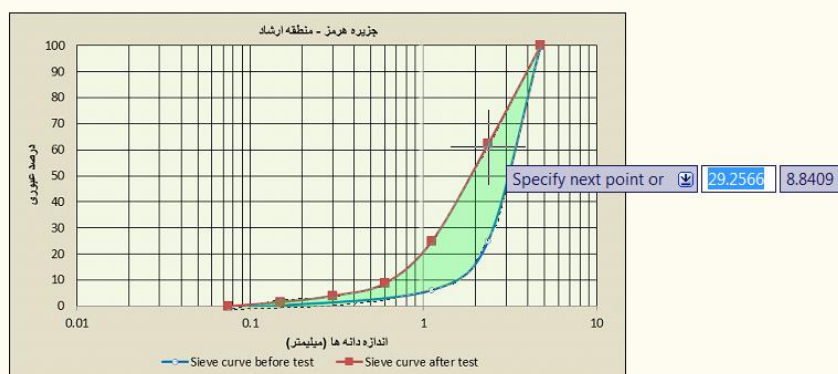
شکل ۸. نمایش محاسبه سطح بین دو نمودار دانه‌بندی قبل و بعد از فشرده‌گی
