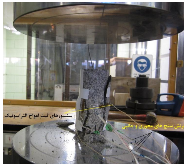
شکل ۱. نحوه آرایش کرنش سنج ها و سنسورهای ثبت امواج صوتی روی مغزه سنگی در آزمایش خستگی
