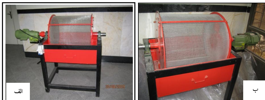
شکل ۳. الف و ب) دستگاه دوام بزرگ مقیاس
