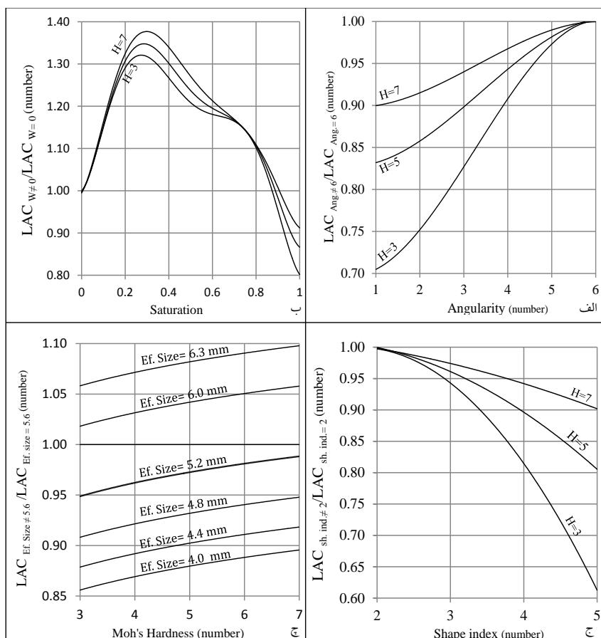
شکل ۸ منحنی‌های مقادیر میانگین تأثیر عوامل سنگ‌شناسی بر میزان سایش، (الف) تأثیرات زاویداری بر میزان سایش نمونه، (ب) تأثیرات درجه اشباع بر میزان سایش نمونه (آب با دمای ۲۵ و pH خنثی)، (ج) تأثیرات شکل دانه‌ها بر میزان سایش نمونه، (د) تأثیرات اندازه دانه‌ها بر میزان سایش نمونه
