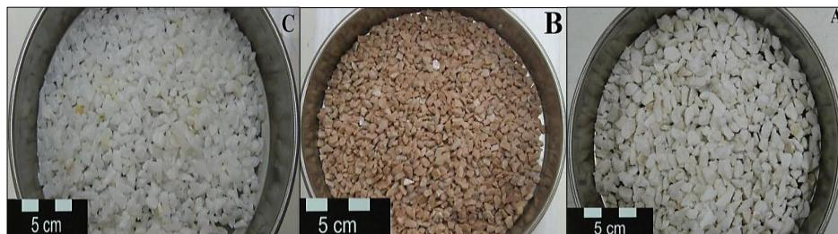
شکل ۴. تعدادی از نمونه‌های آماده شده برای آزمایش؛ (A) کلسیت، (B) ارتوز و (C) کوارتز هم‌چنین چنان‌که در جدول ۳ نشان داده شده است برای بررسی تأثیر اندازه دانه‌ها بر روی سایش در هر یک از انواع نمونه‌های تهیه شده (شکل ۴)، از هفت نوع دانه‌بندی استفاده شده است.
