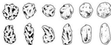
شکل ۷. انواع زاویه‌داری دانه‌های استفاده شده در این تحقیق [۱۵]
