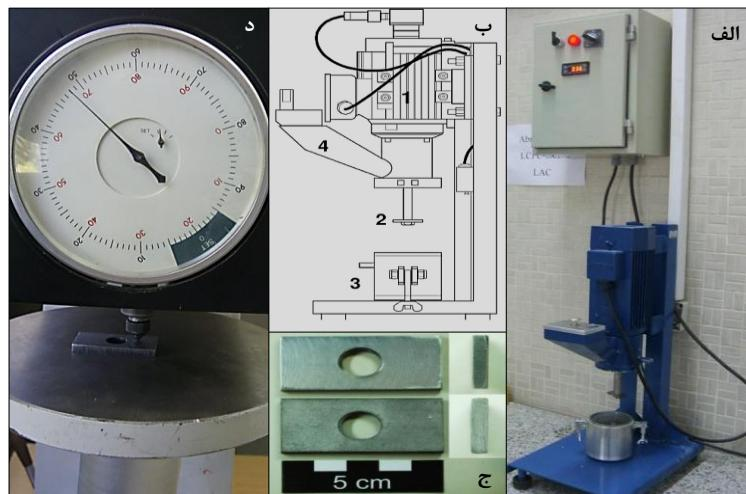
شکل ۱. الف) دستگاه سایش LCPC (دانشگاه فردوسی مشهد)، ب) شکل شماتیک دستگاه LCPC. ۱. موتور، ۲. ایمپلر، ۳. ظرف نمونه، ۴. فانل تیوب (Funnel Tube)، ج: نمونه ایمپلر و د) اندازه‌گیری سختی راکول (R8 HRB)
