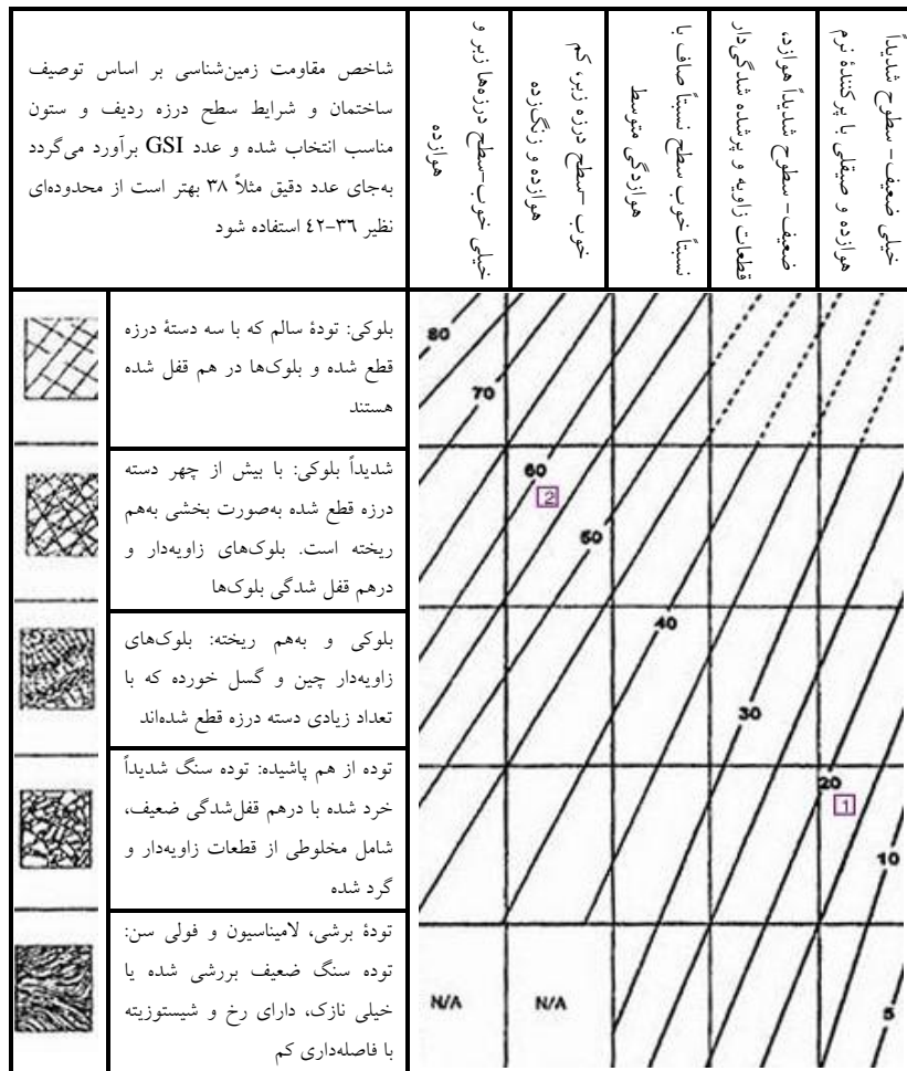
شکل ۸. طبقه‌بندی GSI توده‌های سنگی منطقه
