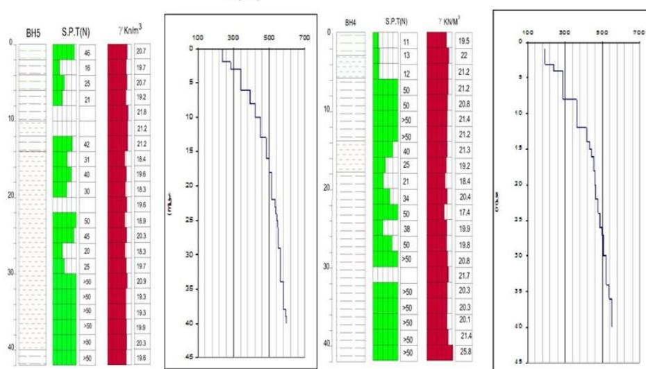
شکل ۵. پروفیل ژئوتکنیکی و ژئوفیزیکی گمانه ۴
