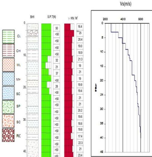
شکل ۲. پروفیل ژئوتکنیکی و ژئوفیزیکی
