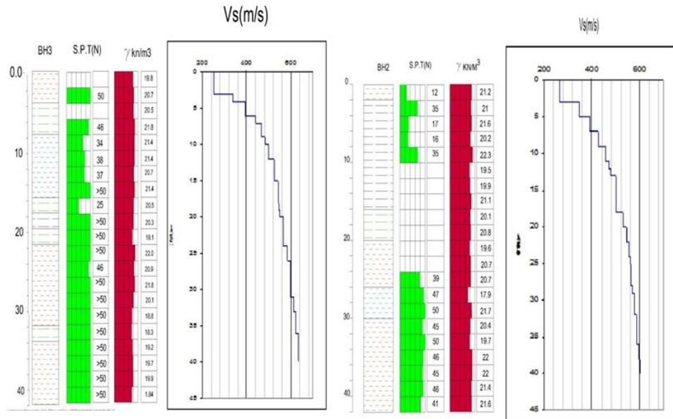
شکل ۴. پروفیل ژئوتکنیکی و ژئوفیزیکی گمانه ۲
