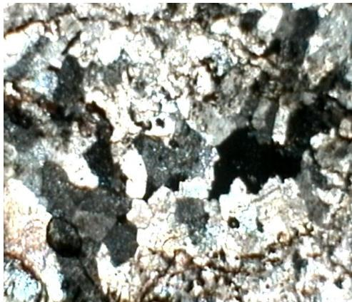
شکل ۵. شکل دیجیتالی از مقطع نازک متعلق به نمونه سنگ تراورتن قرمز
