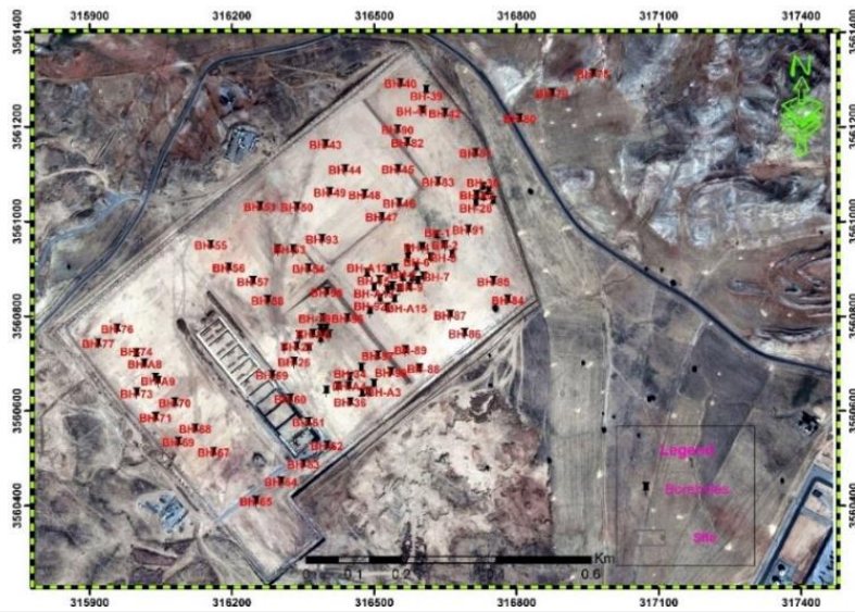
شکل ۳. موقعیت کل گمانه‌های ژئوتکنیکی حفرشده
