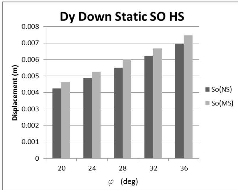
شکل ۳. تغییر مکان قائم پایین تونل در تحلیل‌های استاتیکی با مدل رفتاری خاک سخت شونده در دو حالت با امکان لغزش (NS) و بدون لغزش (MS) در خاک سست
