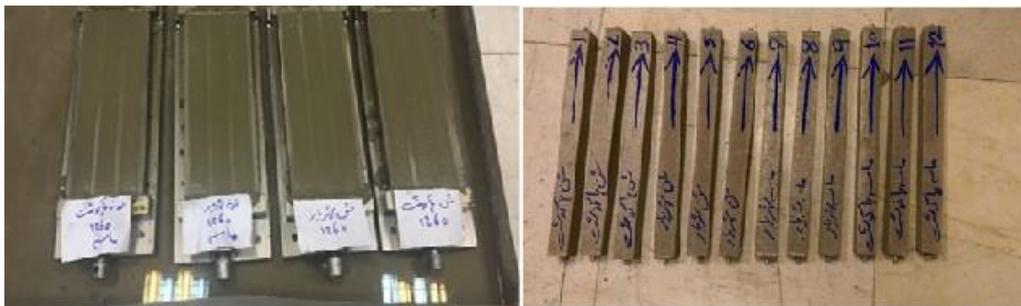
شکل ۴. نمونه های میله ملات تسریع شده (ASTM C 1260)
