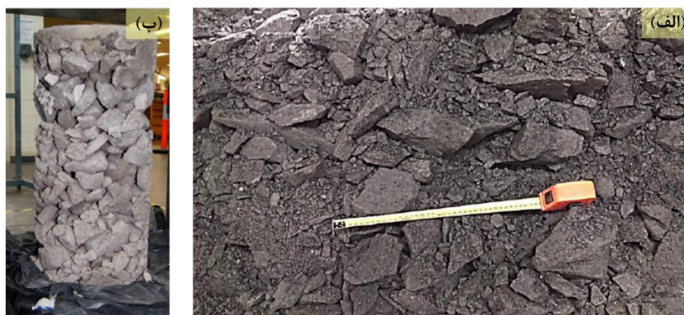
شکل ۳. (الف) سنگدانه مورد استفاده در پرکننده سنگی و (ب) نمونه تهیه شده پرکننده سنگی (Sainsbury et al., 2021) Fig. 3. (a) Aggregate used in rock backfill and (b) a sample of rock backfill
